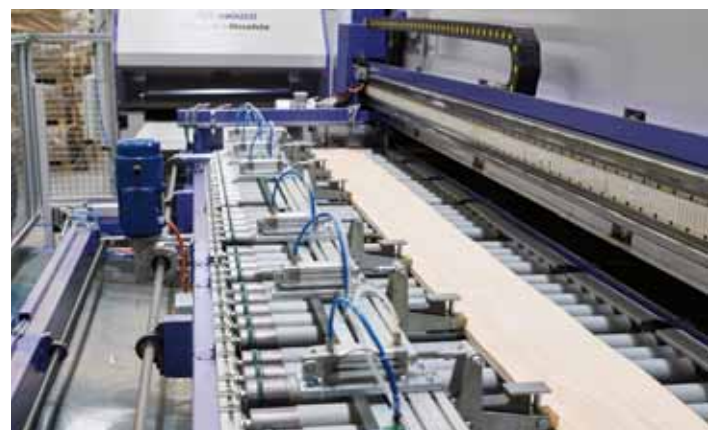
Austragevorrichtung und Weiterleitung zur Auffächerung
