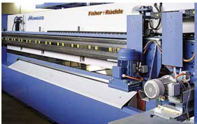
Leim- und Fräsaggregate auch rückseitig
